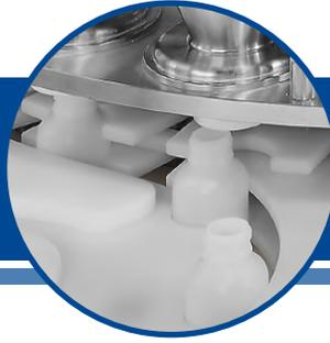
CVC 6088-R16 回转式粉末充填机，搭配一套伺服螺杆组可精密计量并将定量的粉末充填到回转下料口并同步搭配回转载瓶星盘将粉末高速连续充填入瓶内。
